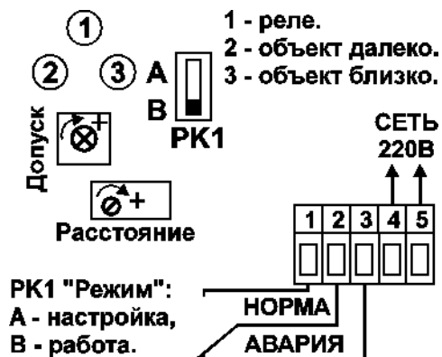
Рис. 7. Схема подключения, органы регулировки и индикации датчика.
